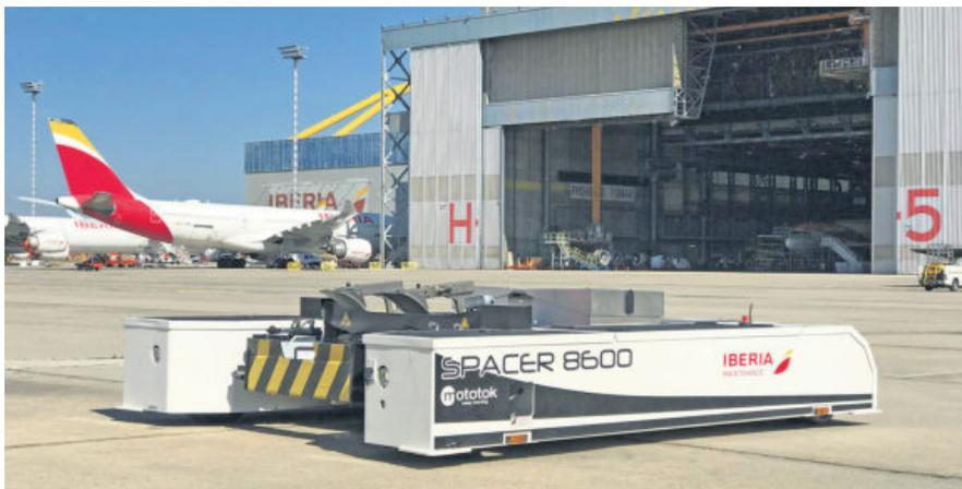
**Iberia Airport Services incorpora tractores de aviones eléctricos y a control remoto.** Iberia Airport Services ha incorporado ocho unidades de tractores de aviones eléctricos que se dirigen por control remoto y se utilizan para remolcar el avión hacia atrás antes de la salida de cada vuelo. El operador de *handling* de Iberia utilizará estos vehículos, que reducen las emisiones de CO2, en los aeropuertos de Madrid y Barcelona.
