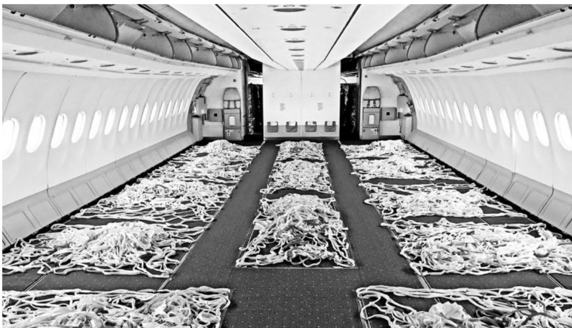
**IAG Cargo se adapta a la 'nueva realidad'.** Iberia transformará este mes tres aviones Airbus A330, que realizarán vuelos solo con carga. Se han instalado 33 posiciones de carga en el suelo, donde se colocará la mercancía. Esta configuración permite llevar unas 18 toneladas de carga en cabina, adicionales a la capacidad en las bodegas.
