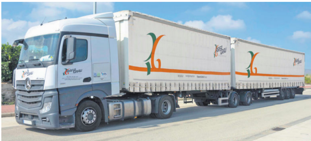
Una de las megacamiones de Rafa Grau Transports, con una longitud de 25,25 metros y una capacidad de carga de 35 toneladas. Foto: RGT
