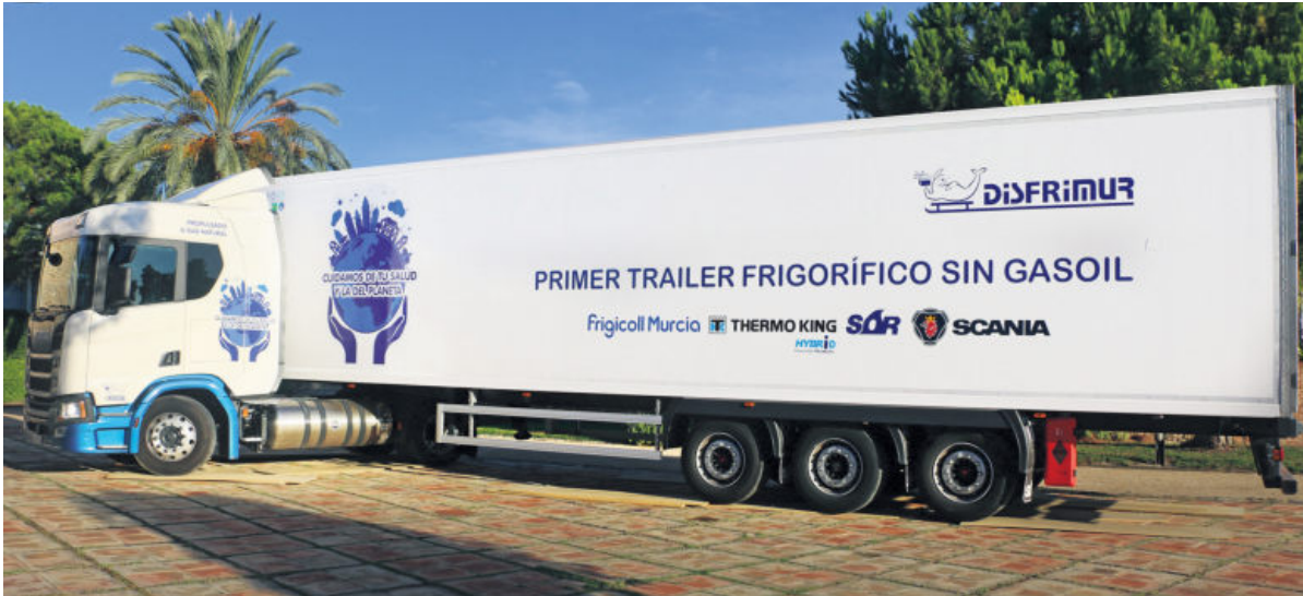
Nuevo conjunto articulado frigorífico de Disfrimur que solo emplea el gas natural licuado como energía.
