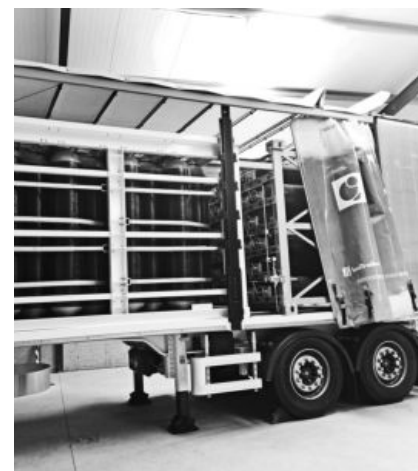
Equipo móvil de suministro de hidrógeno.
