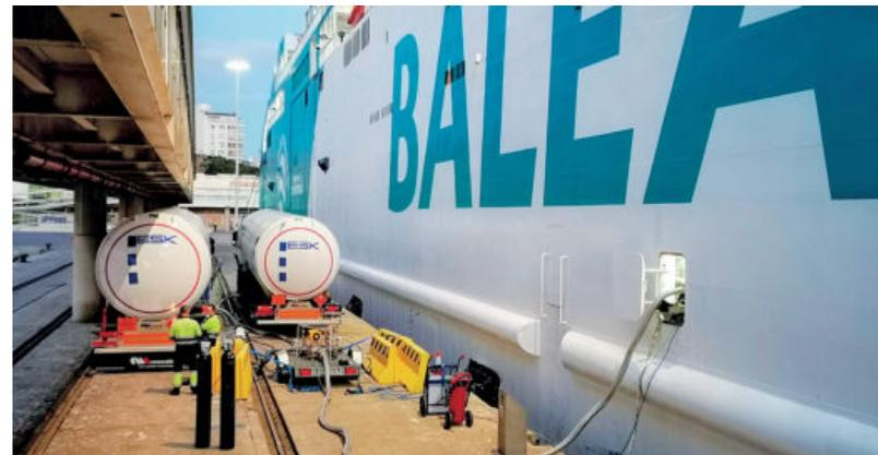
Operación de bunkering con gas natural licuado en el puerto de Almería.
